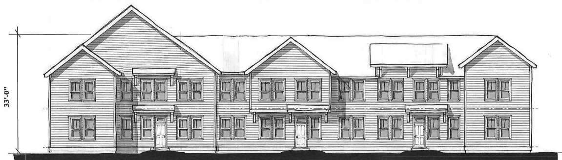
① Mahaiwe Street Elevation SCALE: 1/8" = 1'-0"
